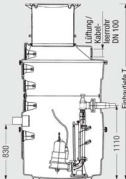
**Pumpstation Aqualift F im Komfort-Schachtsystem LW 1000** aus PE-HD
